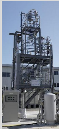
図③ 3塔式コールドモデル (JCOAL、大阪ガス)
