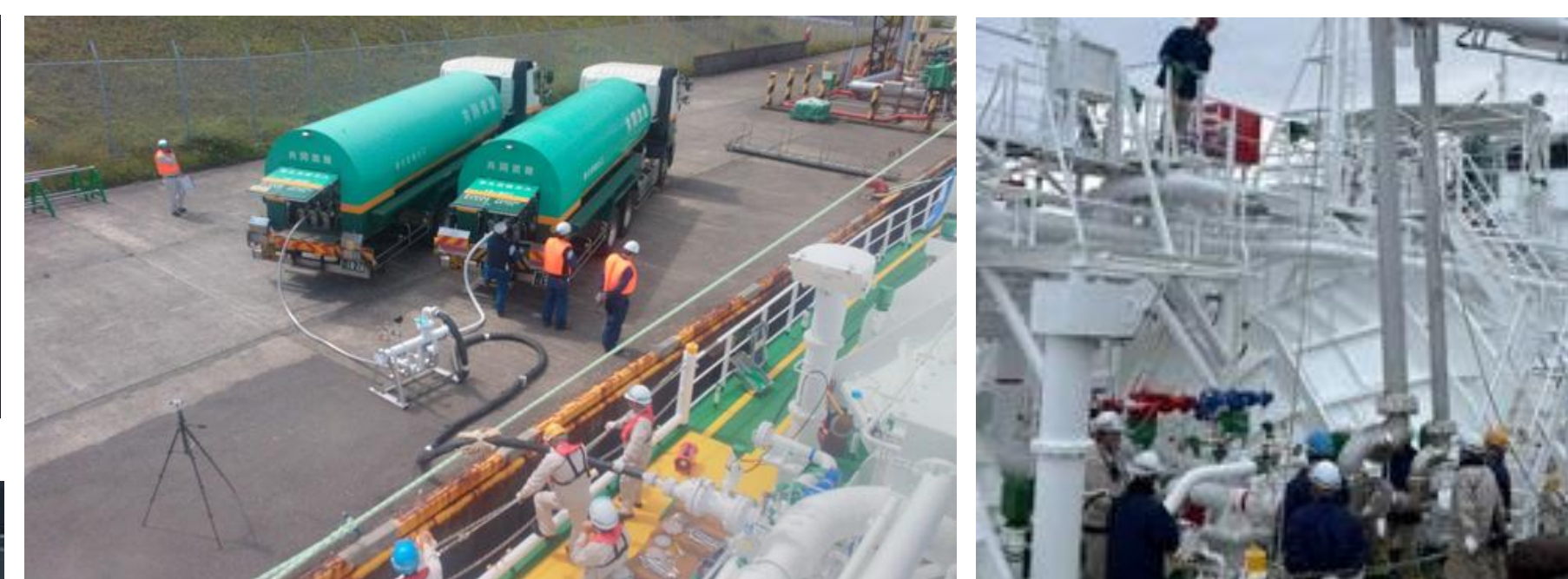
＜タンクローリーとの荷役＞
