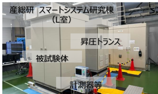
Fig. B社のラボ試験外観
