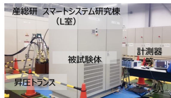
Fig. C社のラボ試験外観
