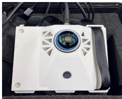
図 バックパック型地上LiDAR
