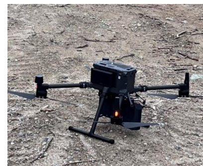
図 ドローン型航空LiDAR
