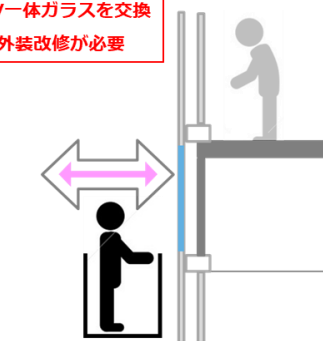
従来の外壁太陽光パネル
