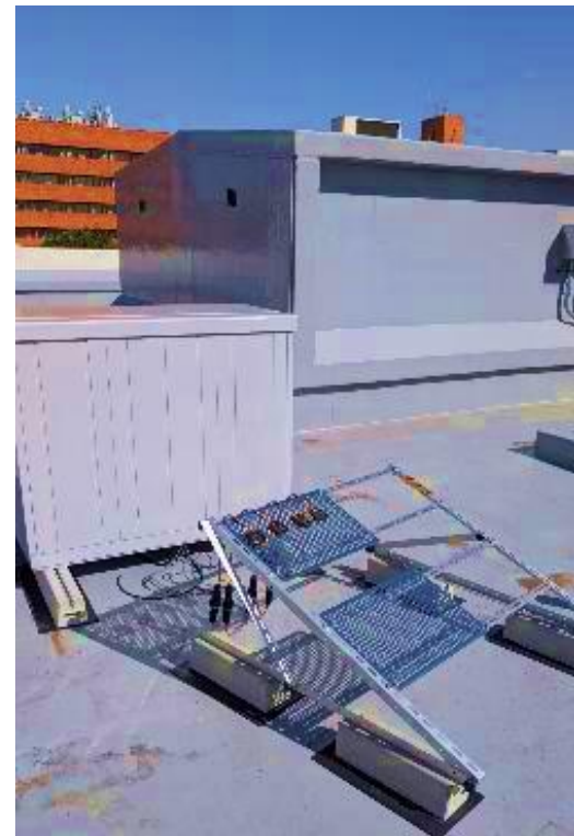
ペロブスカイト太陽電池セルの屋外暴露試験の様子
