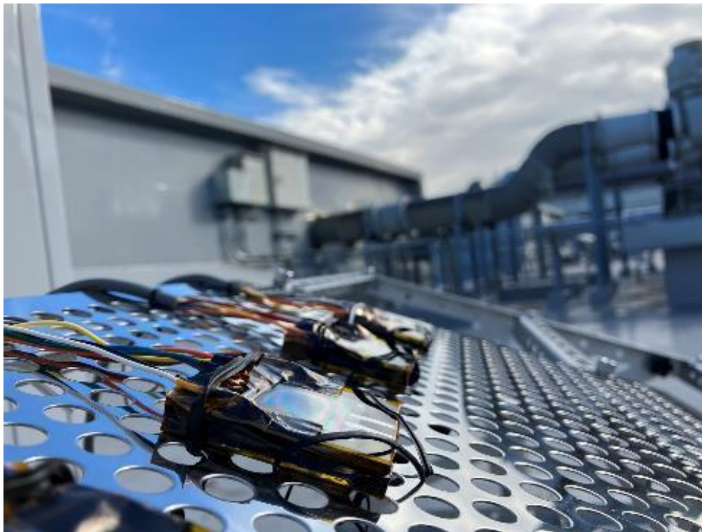
ペロブスカイト太陽電池セルの屋外暴露試験の様子
