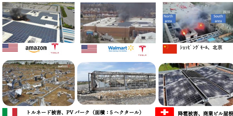
図 6. 代表的な海外 PV システム事故事例
