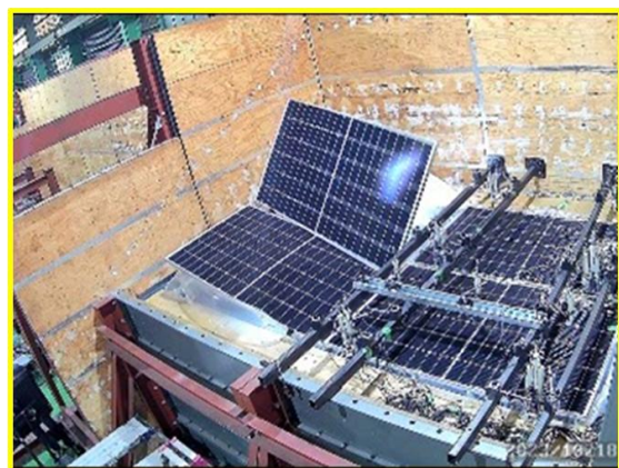
スレート屋根に設置されたPV設備の耐風圧試験
