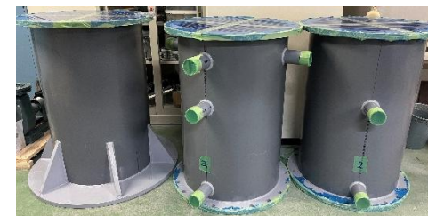
メインタンク (高さ1m×3段)
