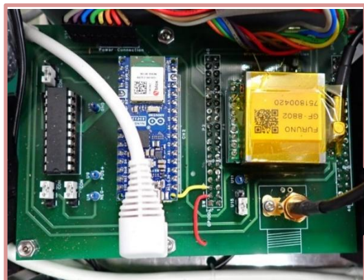
試作したタイマー回路 (周波数を0.01Hzの精度で設定可能)
