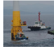
三隻のタグボートを使用し強制変位を付加
