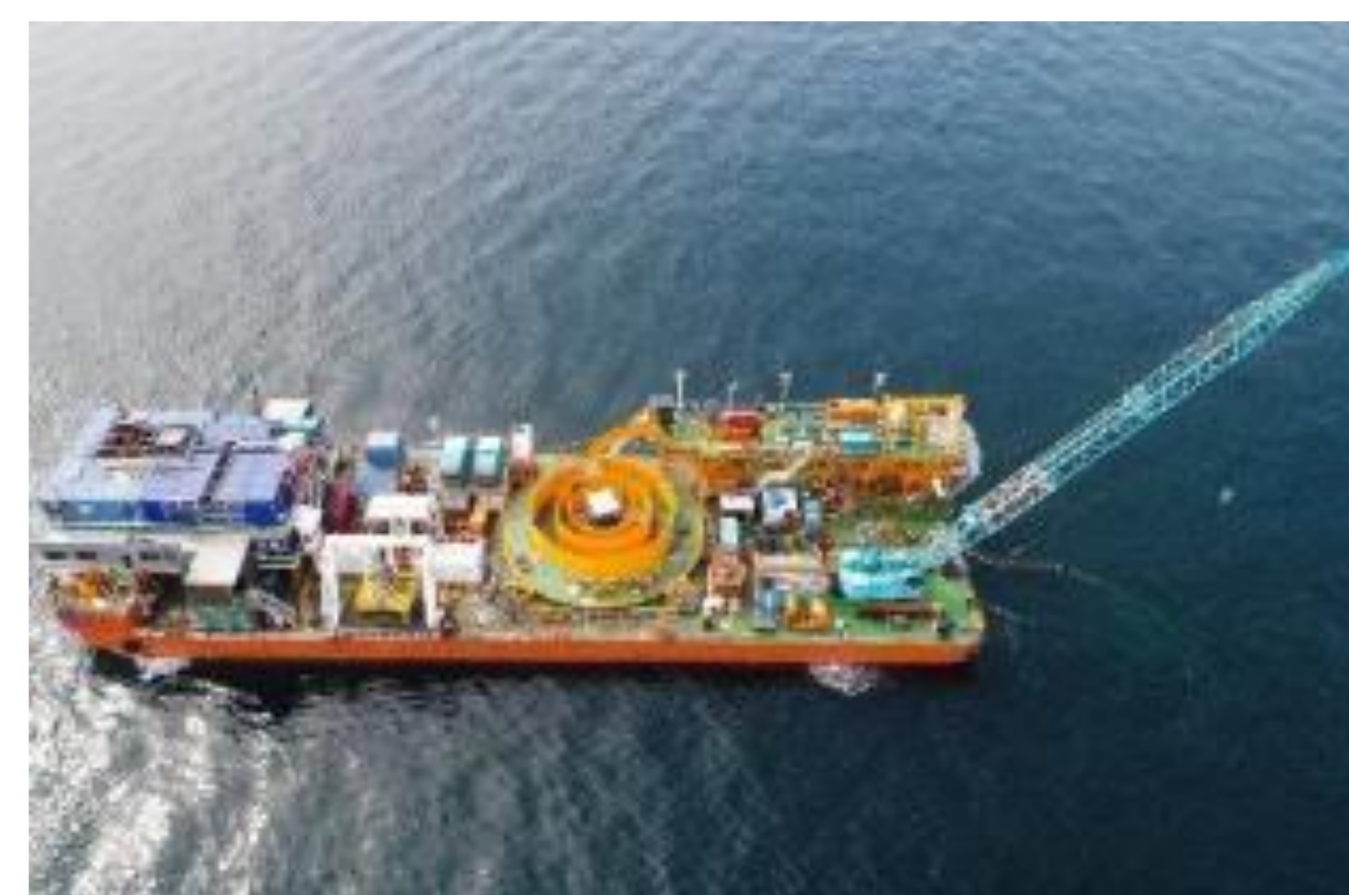
海底ケーブル敷設台船（関海事工業所）
