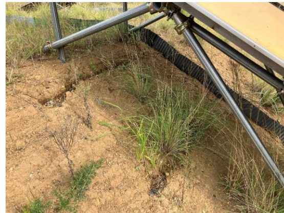
傾斜地設置型PVの地盤侵食保護に関する実証実験の状況
