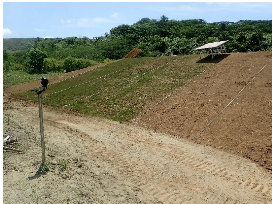
傾斜地設置型PVの地盤侵食保護に関する実証実験の状況
