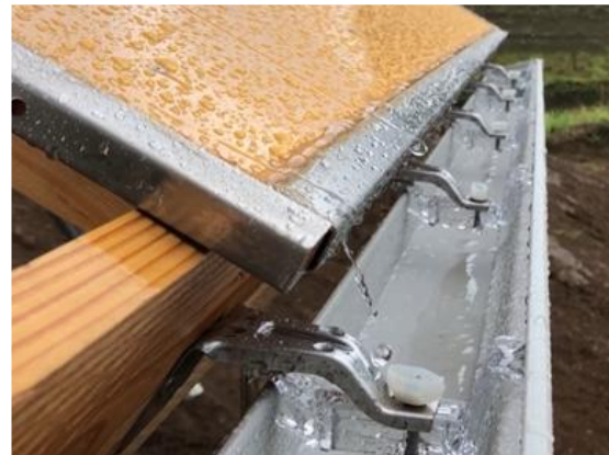
傾斜地設置型PVの地盤侵食保護に関する実証実験の状況
