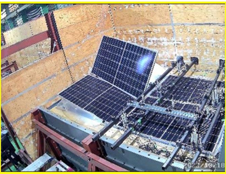
スレート屋根に設置されたPV設備の耐風圧試験
