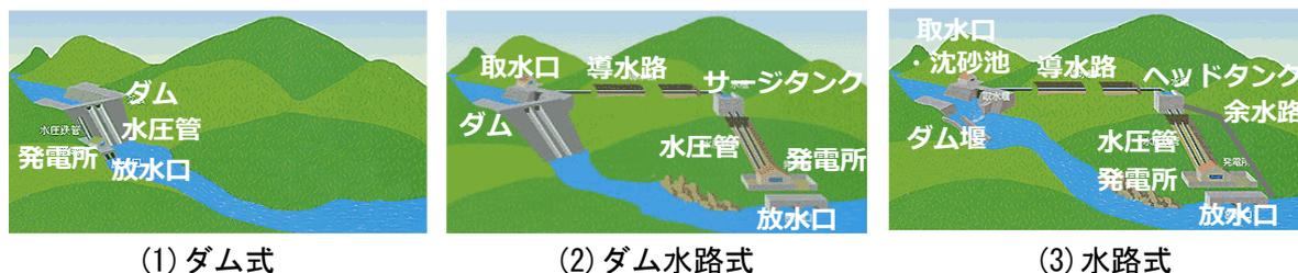
図 3.2.1 落差を得る方法による分類
