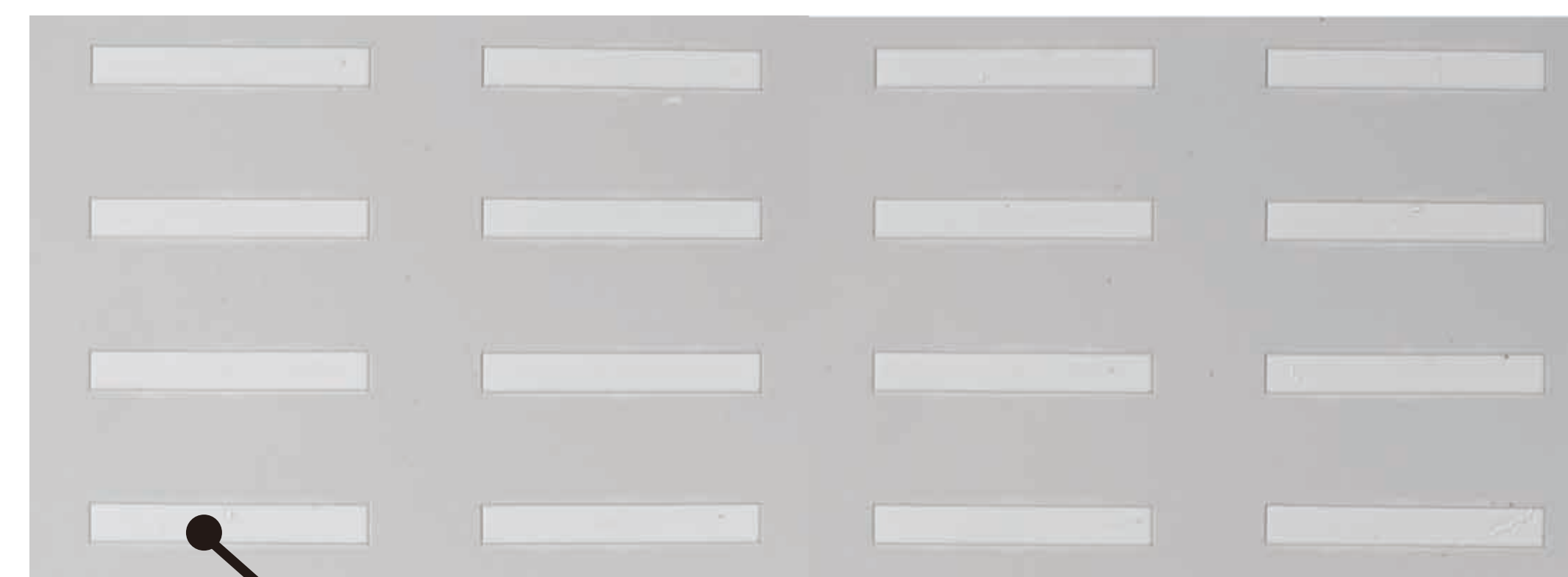
光半導体チップの適用例 (640μm × 90μm、厚さ<1μm)
