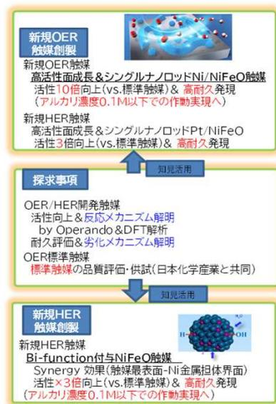
**③アニオン膜型水電解セルの高性能化・高耐久化**
