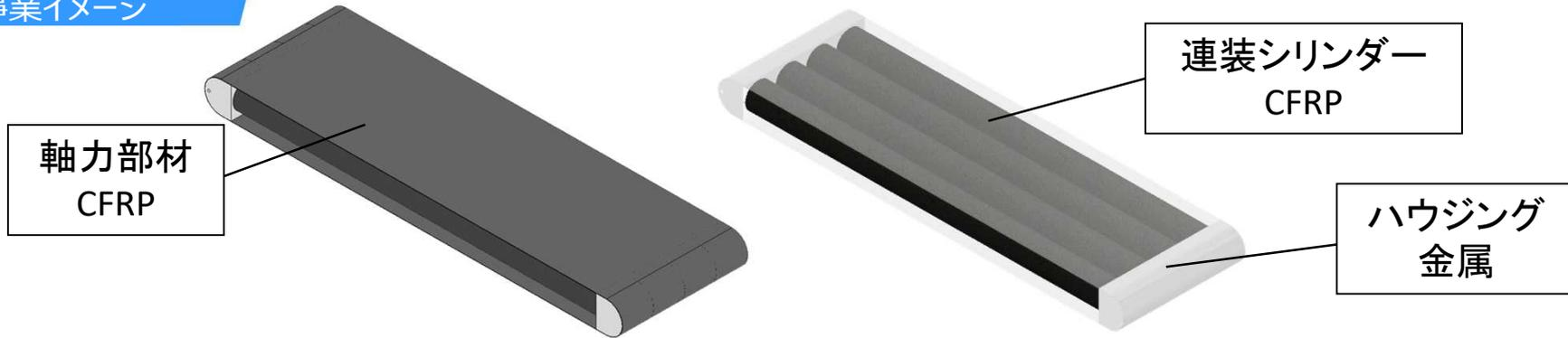
複数のCFRP製シリンダーを横並びに配置，両端を金属ハウジングで接続
