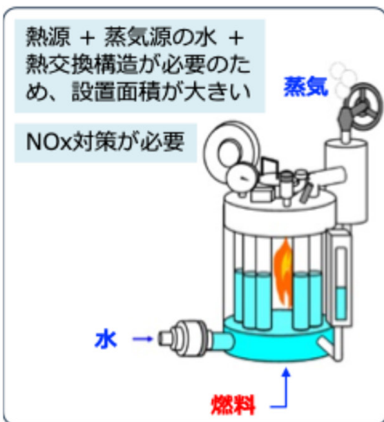
図 間接加熱ボイラと酸素水素燃焼直接加熱ボイラの比較
