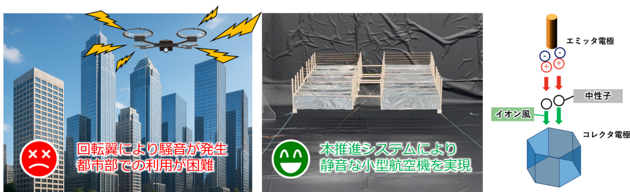
図1 本研究の概要と固形電気空力推進システムの原理
