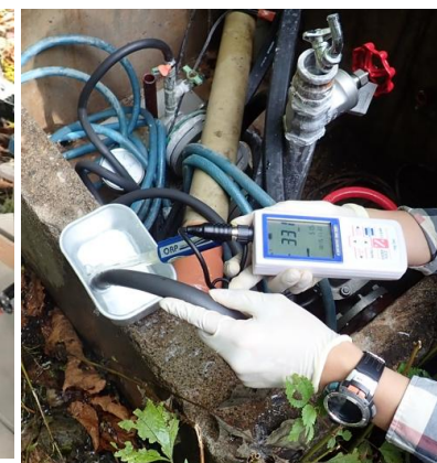
水質調査（温度，pH，酸化還元電位，溶存酸素濃度，塩濃度など）
