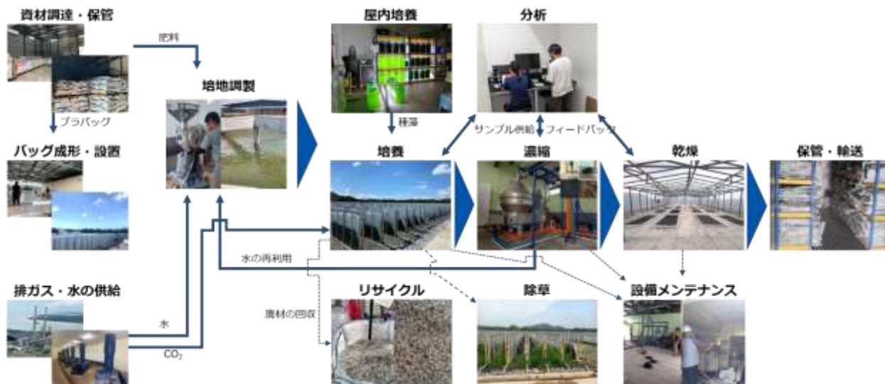
図 2. 微細藻類バイオマスの生産プロセス概略図
