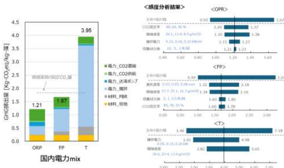
Fig. 7 400~1,000L 規模の試験結果をもとに、産業規模に置き換えた培養工程での GHG 排出量および感度分析結果
