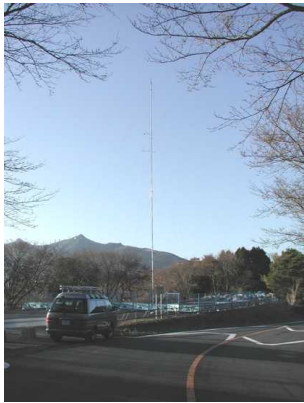
IEA Wind Task 17に提供した風データの風況計測地点（茨城県つくば市表筑波スカイライン六所平駐車場、気象観測マスト：30 m、カップ風速計・風向計：NRG、超音波風向風速計：Gill WindMaster）
