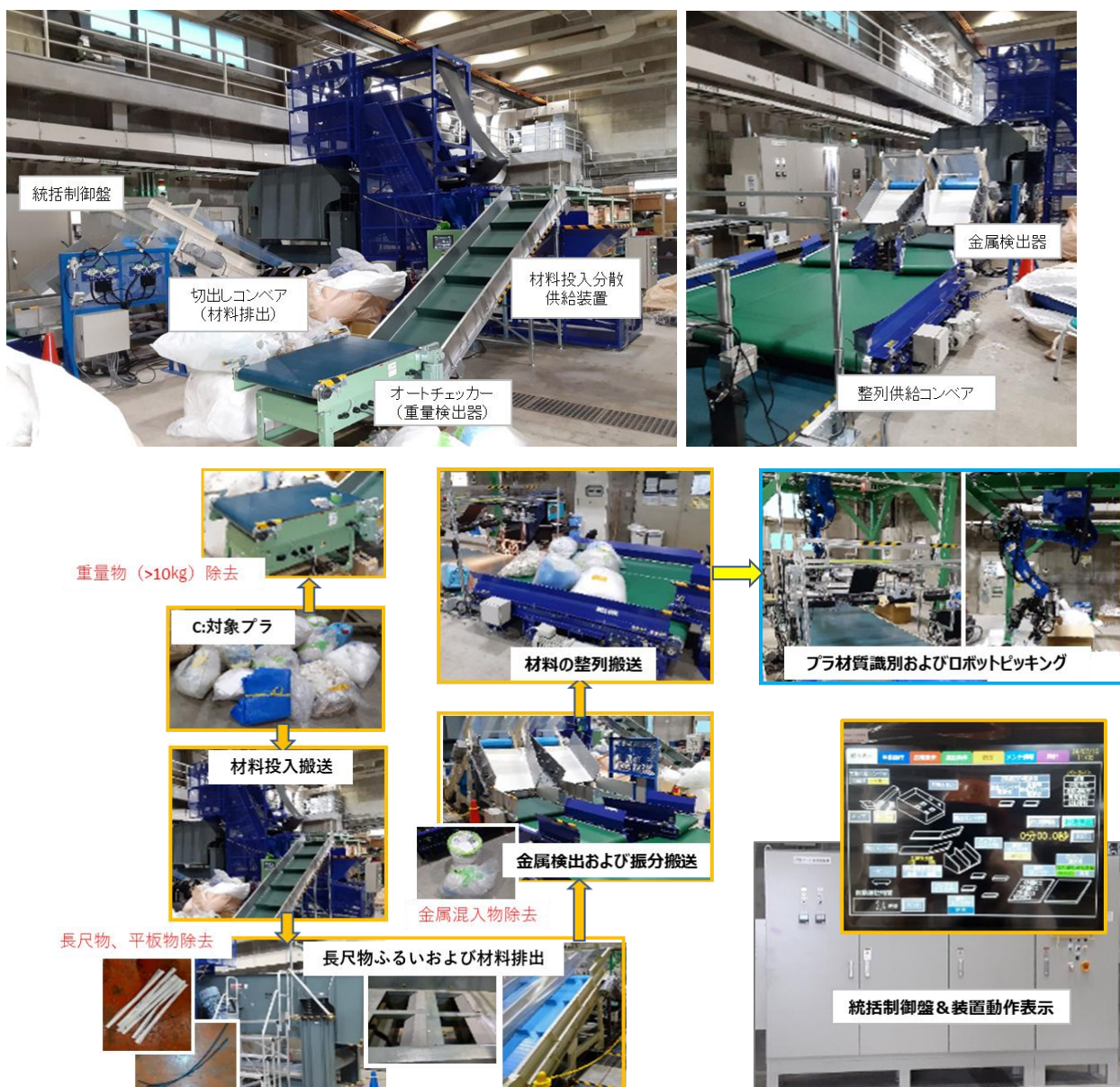
図 3.1.1-23 前処理装置群および処理フロー
