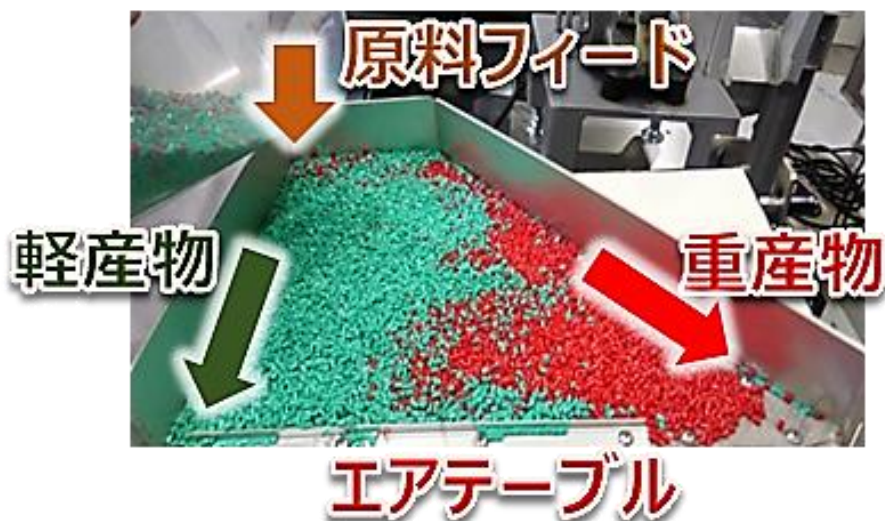
図 3.1.2-25 ポケットエアテーブルでの選別（条件①の例）
