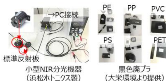
図 3.1.1-20 使用した分光測定機器と測定した黒色廃プラ試料の一部
