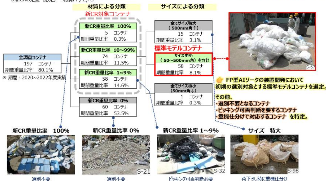
図 3.1.1-5 FP 型 AI ソータの装置開発における標準モデルコンテナの選定
