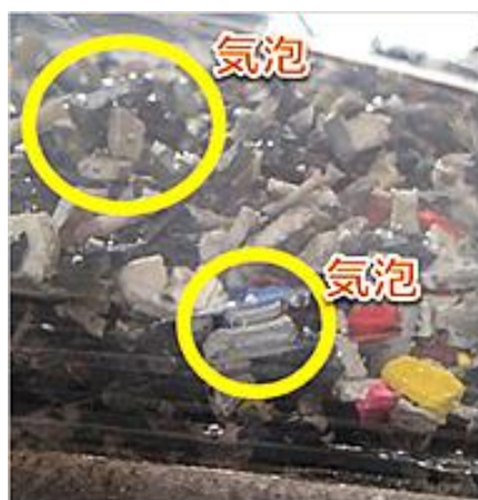
図 3.1.2-23 プラ粒子に付着する気泡
