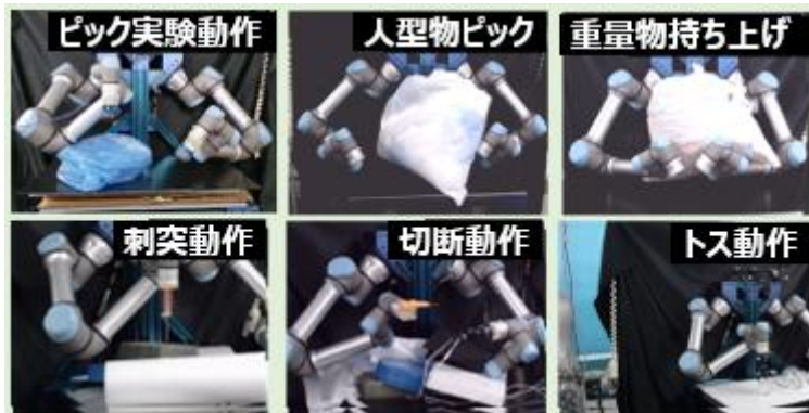
図 3.1.1-28 双腕ロボットを用いたハンドリング動作の検証実験
