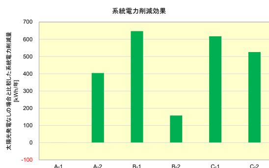
図 1.2-2 太陽光発電システム搭載自動車 (PHEV) 1 台あたりの系統電力削減効果 (PHEV, 太陽光発電容量 1kW, 蓄電池容量 15kWh)
