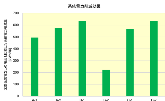
図 1.2-1 太陽光発電システム搭載自動車 (BEV) 1 台あたりの系統電力削減効果 (BEV, 太陽光発電容量 1kW, 蓄電池容量 40kWh)
