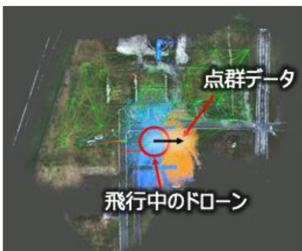
図 6 3次元カラー点群データ生成の様子(左)、現場で作成された3次元点群モデル(右)
