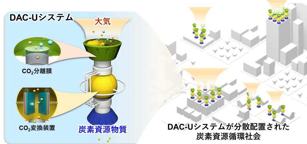
開発中の“どこにでも置けるDAC-U”が、空気中のCO<sub>2</sub>を回収して即資源化。工場やビル、商業施設から家庭まで、“CO<sub>2</sub>をその場で使う”地産地消型の未来を切り拓きます。
