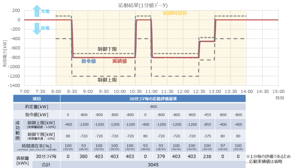
図 149 5月1日応動結果（ケース2：系統用蓄電池）
