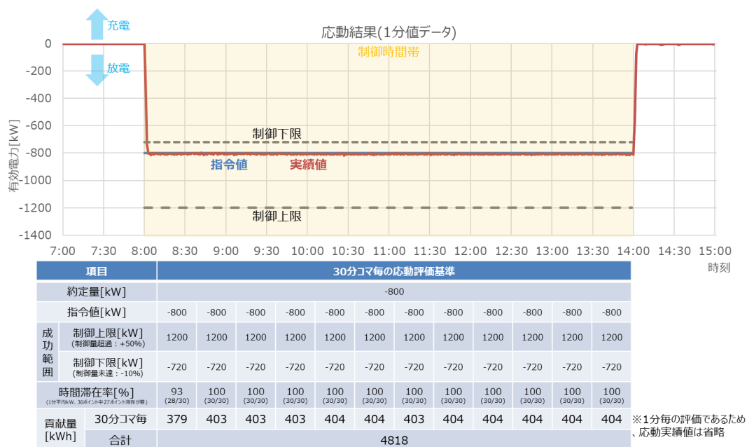
図 140 5 月 3 日 応動結果（ケース 1：系統用蓄電池）
