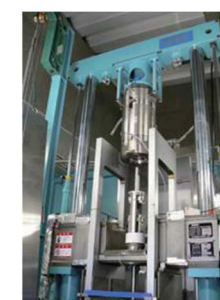
水素圧力：5～20MPa 高圧水素環境下疲労試験装置 (九州大学 HYDROGENIUS)
