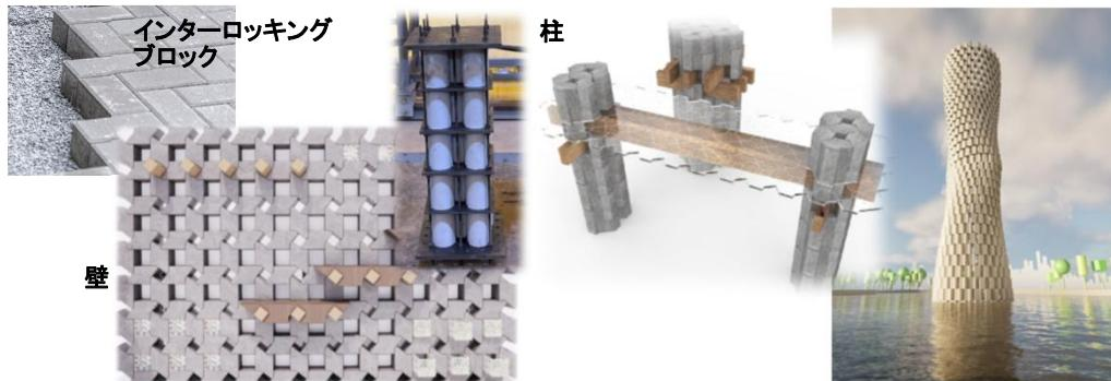
CCC製のブロックを活用して、歩道・公園などを舗装したり、壁・床・塀などを構築したりすることができます。また、CCCを薄肉鋼管で包んだユニットを直列・並列に繋いで緊張材でプレストレスをかけることで、建築物などの柱部材として利用することも可能です。
