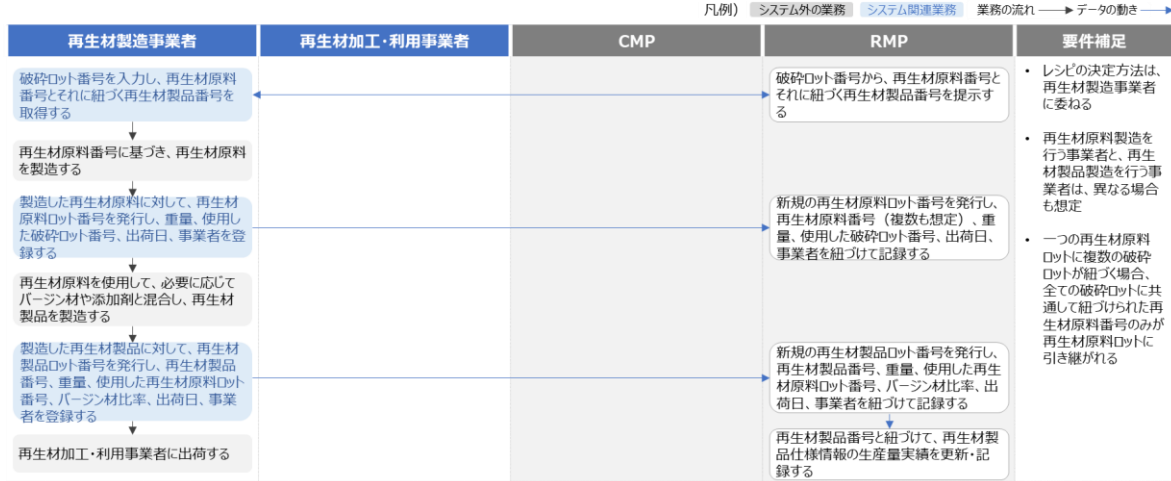
図 18. 業務フロー（8）再生材製造
