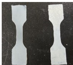
図2 ナイロン 66 試作品（左：50%バイオ品 右：従来品） ラボスケールで確認可能な品質は従来品と同等であることを確認した。
