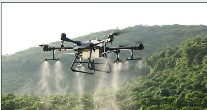
高圧噴射システムを導入したドローン
