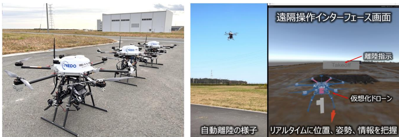
図3 自律分散協調飛行ドローンの外観(左)、遠隔操作インターフェースからの自動離陸(右)
