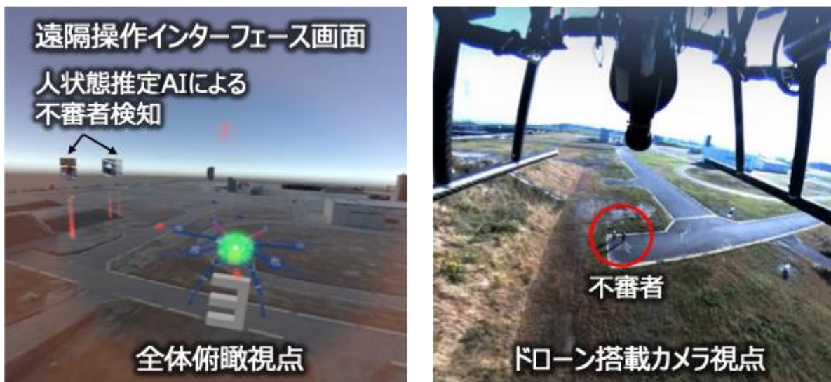
図 5 人状態推定 AI による不審者検知と全体俯瞰提示(左)、ドローン搭載カメラ視点からの映像(右)
