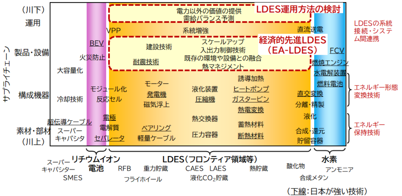
図 3-1-23 貯蔵手法とサプライチェーンを軸にとったエネルギー貯蔵に必要な技術のマッピング
