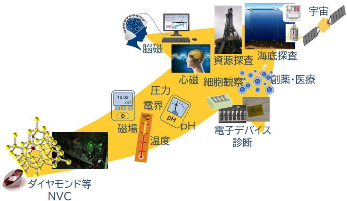
図 3-4-11 ダイヤモンド等 NVC の計測対象と応用分野
