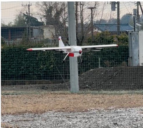
1/3スケール機での飛行試験の様子 回転翼飛行モード ステップ入力(自動飛行)
