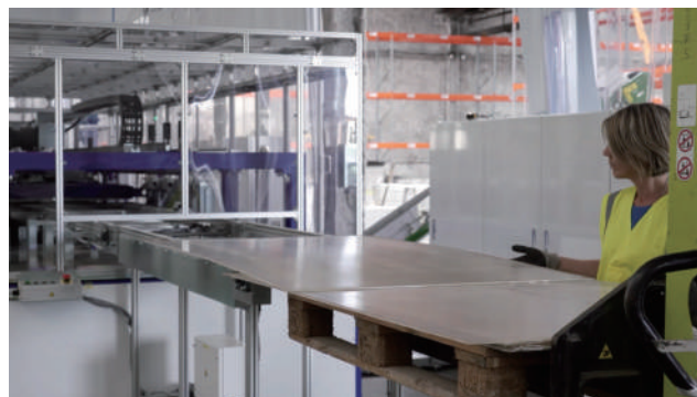
▲フランスで導入されているホットナイフ分離装置
