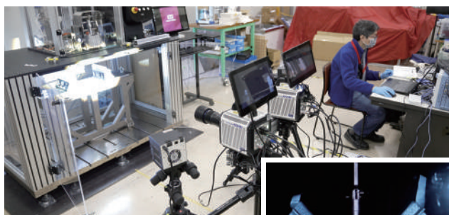
産総研での衝撃試験の様子 (Hat-Beam曲げ試験)
