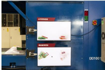
「検知部」では2方向からX線を使って透過画像を撮影
