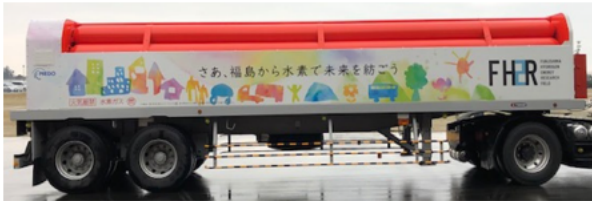
トレーラー（水素貯蔵量：3,000 m3）
