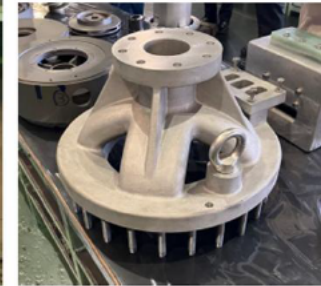
カーゴポンプ 吐出マニフォールド
