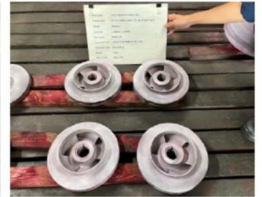
カーゴポンプ インペラ浸透探傷試験時
