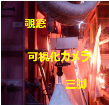
Fig. 可視化カメラでの撮影の様子
