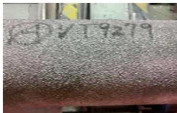
開発材の試作品の鋳肌外面の浸透探傷試験結果 →きず指示なし
