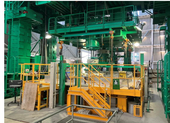
耐火実験炉(柱)
