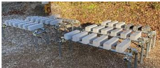
コンクリート試験体の屋外ばく露
