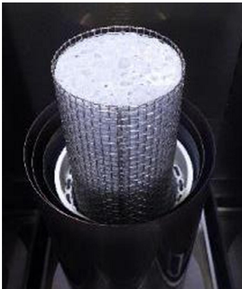
装置内にセットした コンクリート試験体
