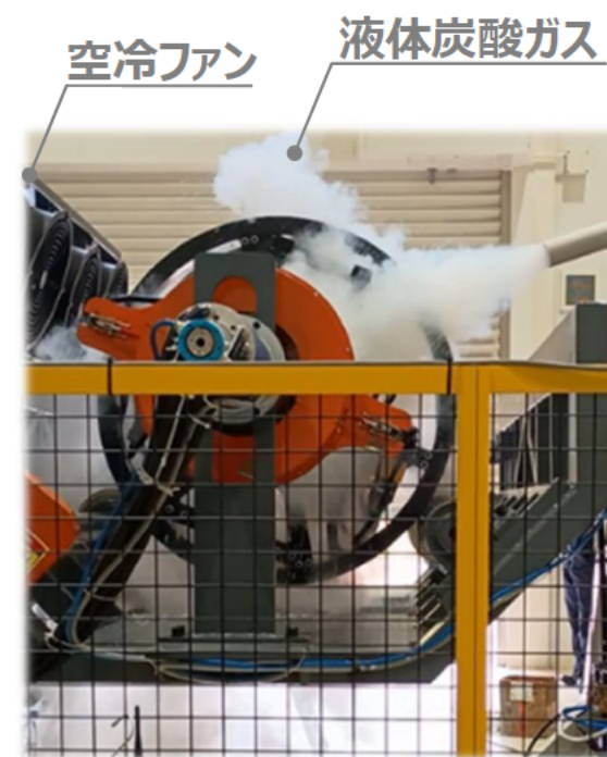
金型冷却テストの様子
