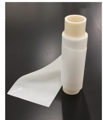
試作AEM膜の外観 (80um × 25cm × 30m)
