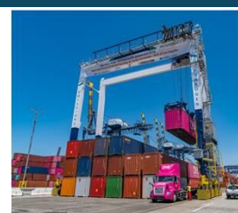
商業運転中の 燃料電池型-RTG
