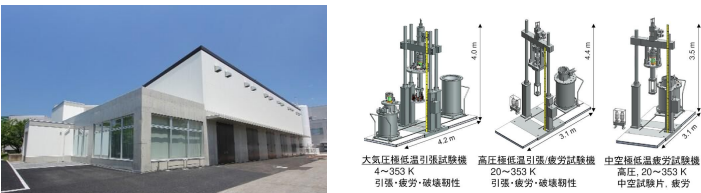
図 特殊実験施設外観および評価試験設備イメージ
