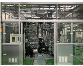
NH3合成触媒評価装置
