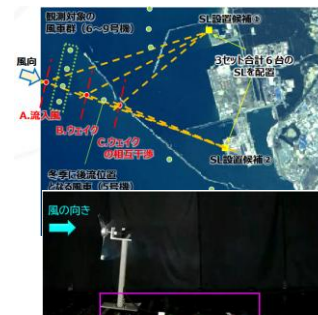
加振装置製作し、浮体の動揺を再現
